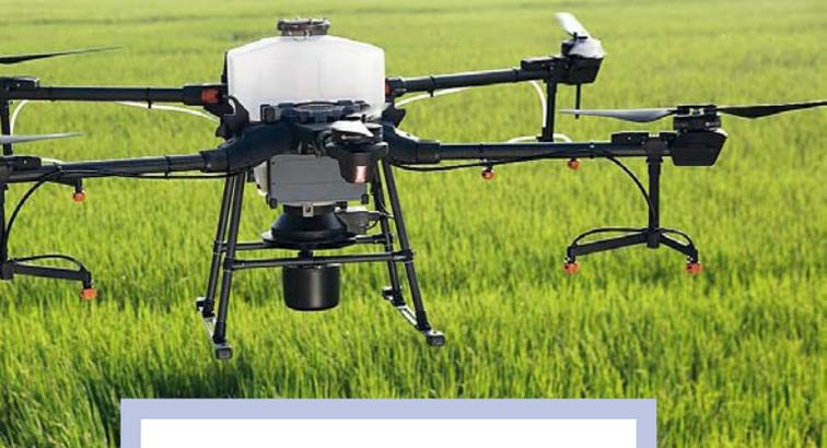
Drone utilizzato per la distribuzione di fitofarmaci. Possiede un serbatoio che contiene la soluzione che viene vaporizzata sulla coltura
